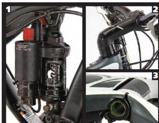
1: il cuore pulsante della Trigger, ovvero l'ammortizzatore DYAD RT2 sviluppato in collaborazione con Fox. 2: i cuscinetti della serie sterzo vengono precaricati da sotto alla piastra inferiore della forcella, consentendo l'utilizzo di questo particolarissimo attacco manubrio 3: le articolazioni del carro sono state fatte oggetto di un generoso dimensionamento.
